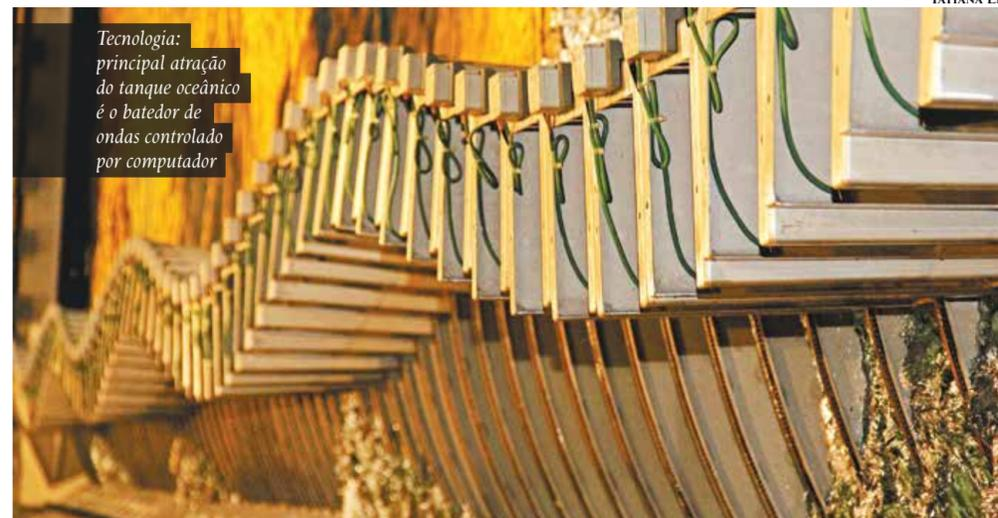
Tecnologia: principal atração do tanque oceânico é o batedor de ondas controlado por computador
